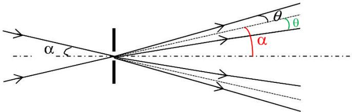
Si  $\theta \geq \alpha$ , la partie "basse" du faisceau supérieur va se superposer avec la partie "haute" du faisceau inférieur. Il sera alors impossible de séparer les deux faisceaux à la sortie de la fente.
