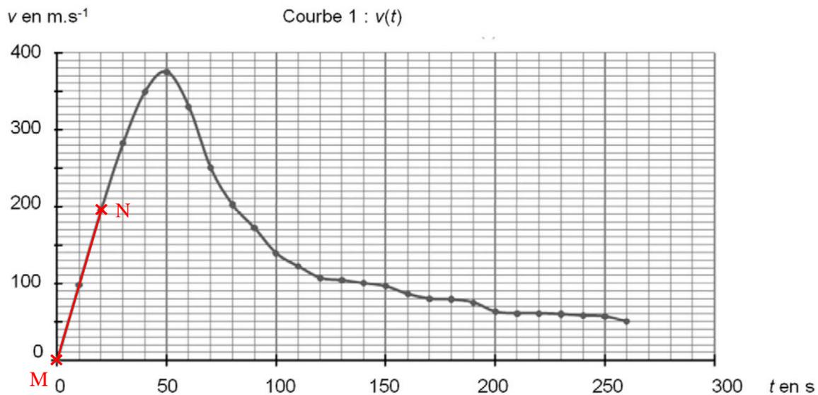
La courbe  $v = f(t)$  peut être assimilée à une droite entre  $t_0 = 0 \text{ s}$  et  $t_5 = 20 \text{ s}$ .
