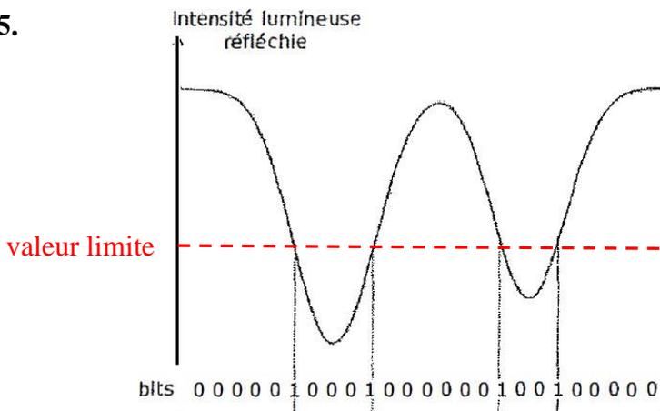
Quand l'intensité lumineuse réfléchie passe par une valeur limite (voir schéma), le bit est codé 1.
