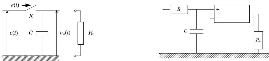
FIGURE 11 – À gauche : Échantillonneur bloqueur; la résistance R_u modélise le circuit d'utilisation. À droite : Échantillonneur bloqueur avec AO parfait. La résistance R représente l'ensemble des résistances en amont, lorsque l'interrupteur est fermé.
