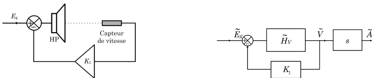
FIGURE 12 – Principe et schéma fonctionnel de l’asservissement en vitesse du haut-parleur.
