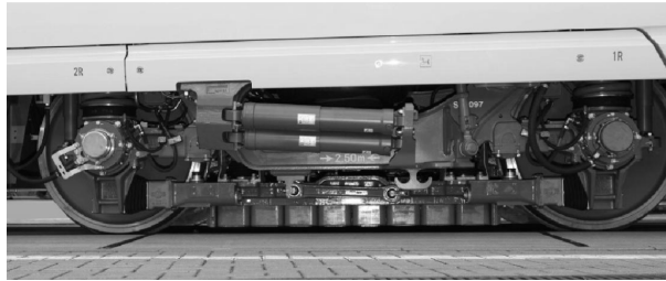
FIGURE 3 – Bobines d’un frein électromagnétique KNORR sur train de type VELARO
