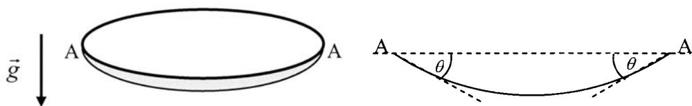
Figure 6 : Film de savon sur un cadre circulaire, vu en perspective et vu en coupe.
