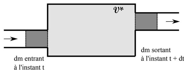
FIGURE 7 – Définition du système fermé effectif dans l'application du premier principe de la thermodynamique à un système ouvert en régime stationnaire. Le système fermé est constitué à l'instant  $t$  du volume de contrôle  $\mathcal{V}^*$  plus la masse  $dm = D_m dt$  entrant pendant la durée  $dt$ . Le système fermé devient à l'instant  $t + dt$  la somme du volume de contrôle  $\mathcal{V}^*$  et de la masse  $dm = D_m dt$  sortant pendant la durée  $dt$ .
