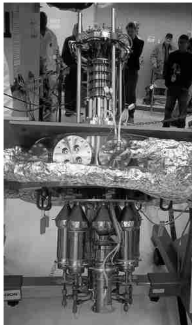
Figure 2 Système de test KRUSTY positionné tête en bas dans une chambre à vide : moteurs Stirling en bas et cœur d'uranium en haut (NASA)
