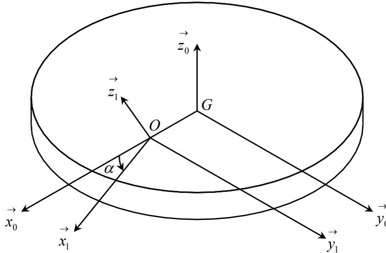
On considère un cylindre homogène de centre de masse  $G$ , de rayon  $R$ , de hauteur  $H$  et de masse  $m$  (voir figure ci-dessus).
