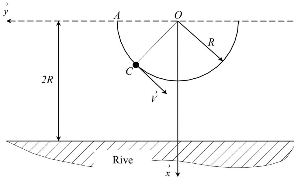
Dans le référentiel galiléen  $\mathcal{R}(O, \vec{x}, \vec{y}, \vec{z})$ , un bateau à moteur, assimilable à un point matériel, décrit dans le plan horizontal  $(O, \vec{x}, \vec{y})$  un cercle de rayon  $R$  avec une vitesse de norme constante  $V$ . Il part du point  $A$  à l'instant  $t = 0$ . A chaque instant le bateau crée des vagues qui se propagent à la vitesse  $\frac{V}{2}$ .
