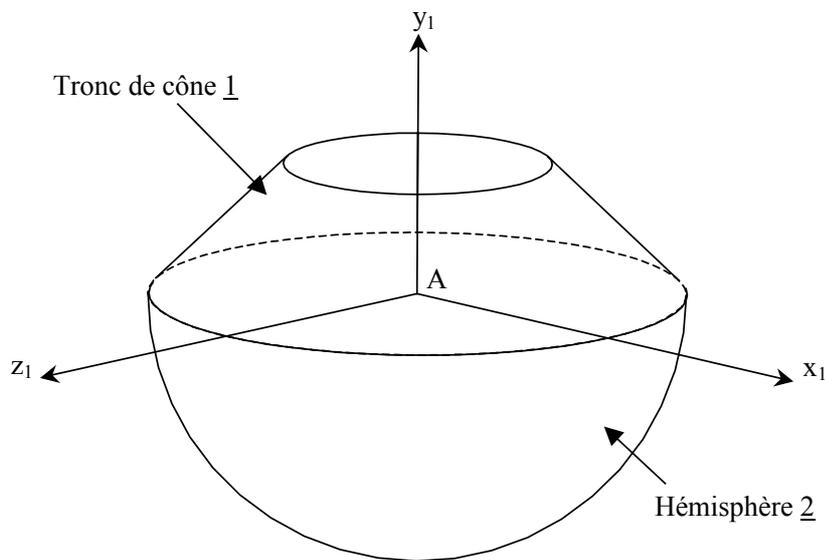
On considère un culbuto ( $S$ ) constitué d'un tronc de cône  $\underline{1}$  sur lequel on a collé un hémisphère  $\underline{2}$  sur sa grande base. Le tronc de cône  $\underline{1}$ , de masse volumique  $\rho_1$ , possède une grande base de rayon  $R$ , une petite base de rayon  $\frac{R}{2}$  et une hauteur  $\frac{R}{2}$ . L'hémisphère  $\underline{2}$ , de masse volumique  $\rho_2$ , est de rayon  $R$ .
