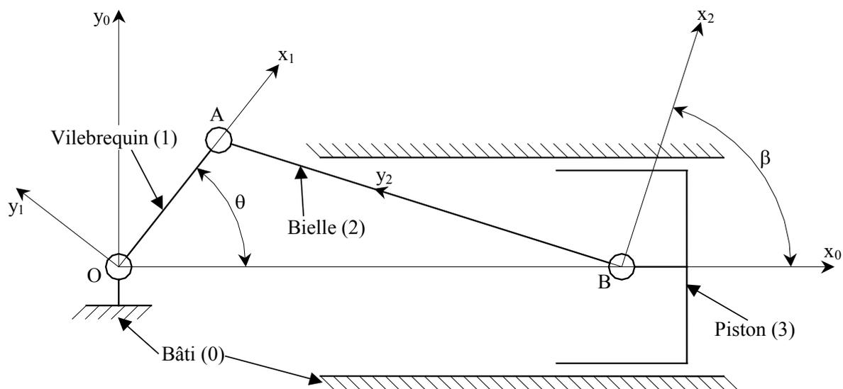
Ce mécanisme équipe les moteurs thermiques et les compresseurs. Il permet de transformer la translation d'axe  $\vec{Bx}_0$  du piston (3) en une rotation d'axe  $\vec{Oz}_0$  du vilebrequin (1) (cas des moteurs thermiques) ou l'inverse (cas des compresseurs).
