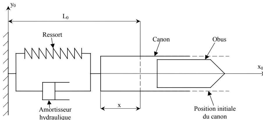
**2.5** En considérant que l'amortisseur hydraulique absorbe une partie  $E_a$  de l'énergie cinétique de recul du canon, déterminer en fonction de  $v_0$  la raideur minimale  $k_2$  que doit posséder le ressort pour limiter le recul à une distance  $d$ .
