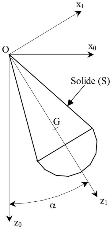
Un solide de révolution (S) d'axe  $Oz_1$ , de masse  $m$ , est fixé sans frottement au point fixe  $O$ . Le solide (S) tourne autour de l'axe  $Oz_0$  à la vitesse angulaire  $\omega$  constante. On ne s'intéressera ici qu'à l'état stationnaire du solide (S), c'est-à-dire lorsque  $\ddot{\alpha} = \dot{\alpha} = 0$ .
