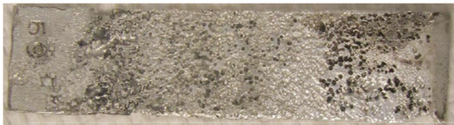
FIGURE 2 – Alliage d'aluminium (6063) exposé dans l'éthanol à 130 °C pendant 24 h.
