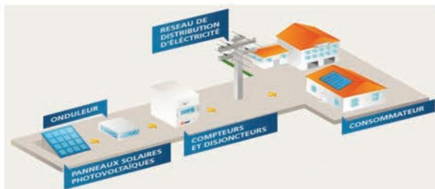
Figure 8. – Installation photovoltaïque raccordée au réseau électrique
