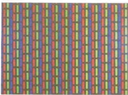
Doc 2 Luminophores d'un écran de télévision.
