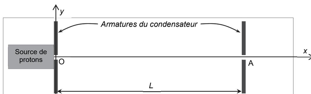
Figure 1. Schéma du dispositif modélisant l'accélérateur linéaire
