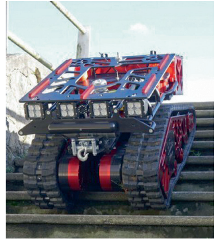
Figure 14 : le robot Colossus descendant un escalier
