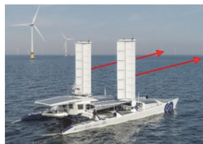
Figure 13 : propulsion de l'Energy Observer avec les Oceanwings
