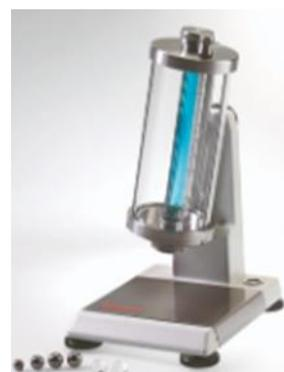
Au lycée, on peut concevoir un viscosimètre analogue à celui de la photo à l'aide d'une éprouvette graduée remplie du fluide étudié au sein de laquelle on étudie la chute d'une bille métallique sphérique. L'objectif de cet exercice est d'étudier la fiabilité des mesures obtenues à l'aide d'un tel viscosimètre.
