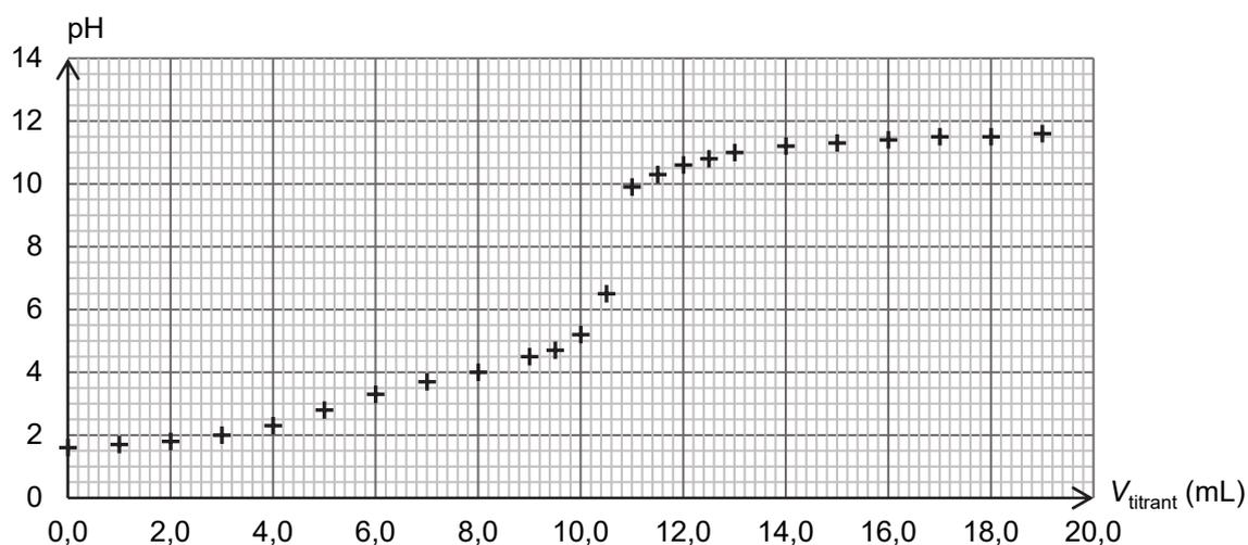
Figure 1. Évolution du pH en fonction du volume versé de solution titrante
