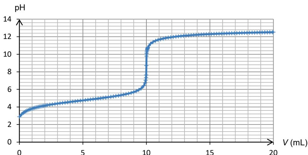
Figure 4. Simulation du titrage de 10,0 mL d'une solution d'un acide faible (acide éthanoïque) de concentration  $0,100 \text{ mol}\cdot\text{L}^{-1}$  par une solution de base forte (hydroxyde de sodium) de concentration  $0,100 \text{ mol}\cdot\text{L}^{-1}$
