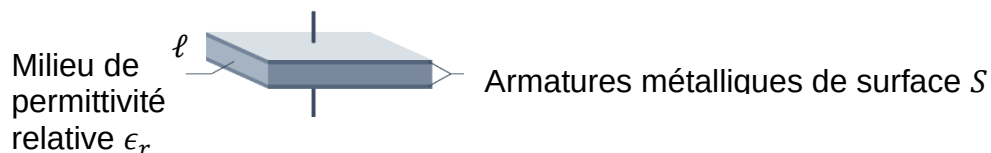
Figure 2 : Représentation schématique d'un condensateur plan
