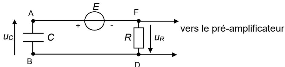
Tension continue délivrée par la source idéale :  $E = 48 \text{ V}$
