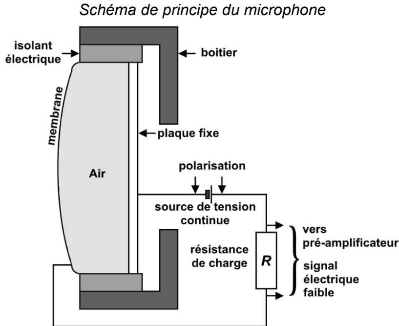
Le condensateur présent dans le microphone est formé de deux armatures ; la première est constituée d'une membrane mobile en plastique recouverte d'une fine pellicule métallique, la seconde est constituée d'une plaque métallique fixe. Lorsque le microphone ne capte pas de son, la distance entre les deux armatures est de l'ordre de 15 à 25  $\mu\text{m}$ .
