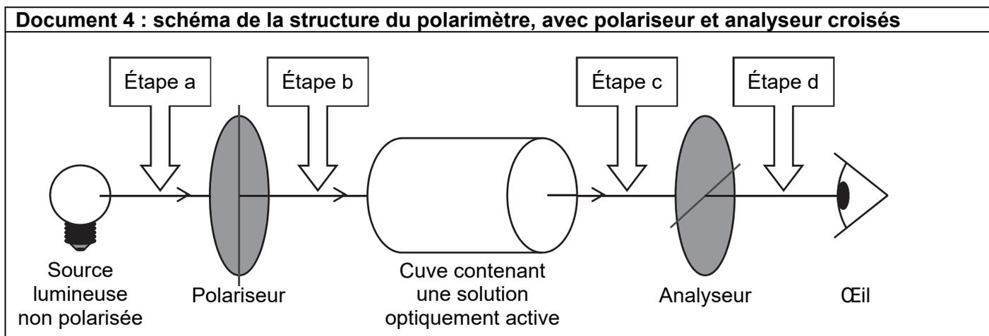
Les orientations du polariseur et de l'analyseur croisés sont orthogonales. Dans ces conditions, en l'absence de solution optiquement active, aucune lumière n'émerge du polarimètre.
