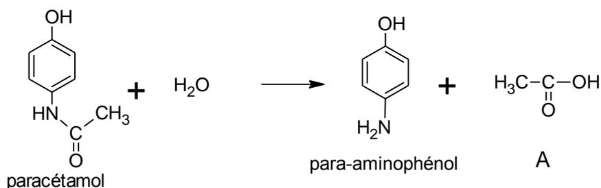
On refroidit ensuite le ballon sous un courant d'eau froide. On verse le contenu du ballon dans une fiole jaugée de 100 mL et on complète jusqu'au trait de jauge avec de l'eau distillée. Soit  $S_1$  la solution ainsi préparée contenant le para-aminophénol à la concentration molaire  $c_1$ .
