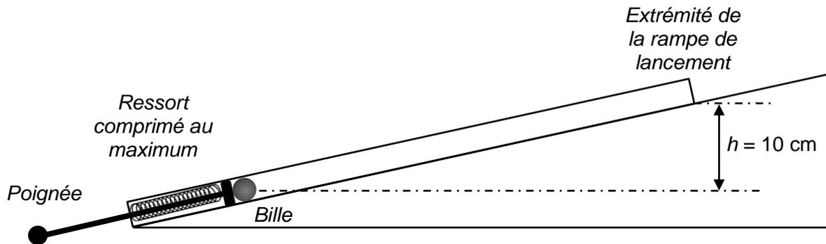
Figure 3 : Dispositif simplifié de la rampe de lancement
