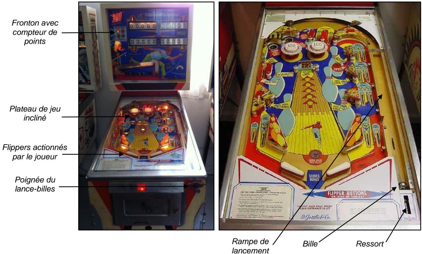
Figure 1 : Vues d'ensemble d'un flipper
