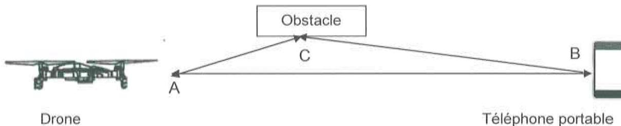
Les signaux transmis en WiFi se dégradent avec la distance et avec les obstacles, ce qui limite la portée et le débit de la liaison.
