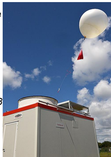
Figure 1 : lâcher de ballon automatique © Météo-France, Pascal Taburet
