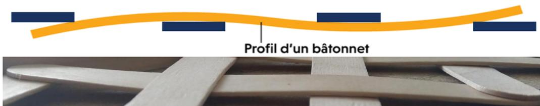
Figure 3 : Schéma de profil d'un bâtonnet déformé dans le croisillon et photo correspondante
