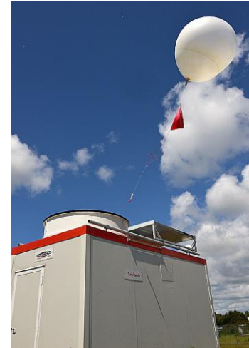
Figure 1 : lâcher de ballon automatique © Météo-France, Pascal Taburet
