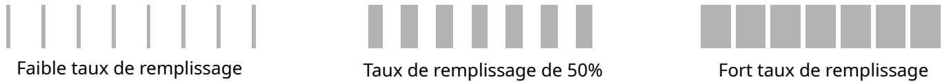
Figure 8: Membrane à cristal photonique avec un taux de remplissage \eta proche de 0 à gauche, égale à 0,5 au milieu et proche de 1 à droite.
