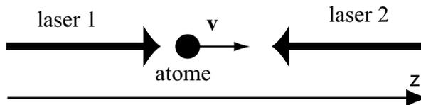
FIG. 2 – Refroidissement unidimensionnel
