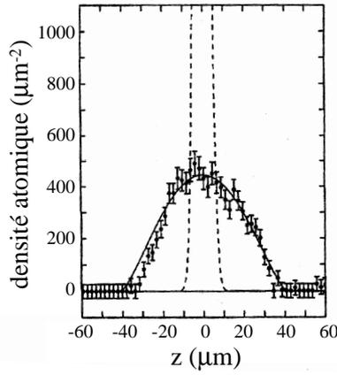
FIG. 4 – Densité atomique dans un condensat contenant 80 000 atomes de sodium en fonction de l’altitude  $z$  (points noirs avec barres d’erreur). En trait plein, ajustement par une parabole inversée. En traits pointillés, profil de densité de l’état fondamental d’un condensat dans un piège harmonique sans interactions.
