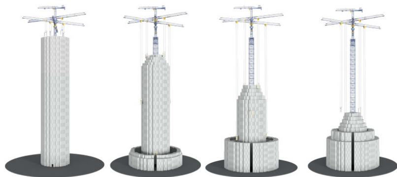
Document 10 : photographie du prototype d'Energy Vault, et schéma de principe qui montre le stockage des blocs de béton.
