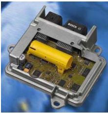
FIGURE 1 – Schéma d'un détecteur de choc et photo du détecteur sur son circuit électrique
